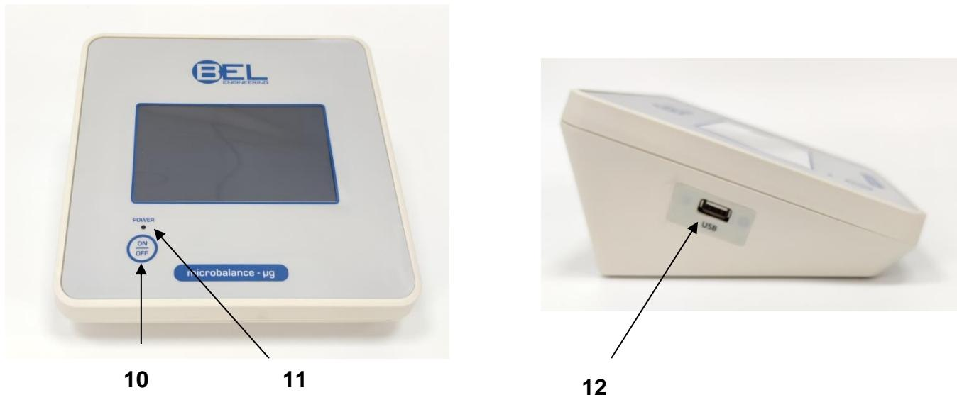
После подключения блока питания к сети весы запускаются автоматически без нажатия кнопки питания. (10).
