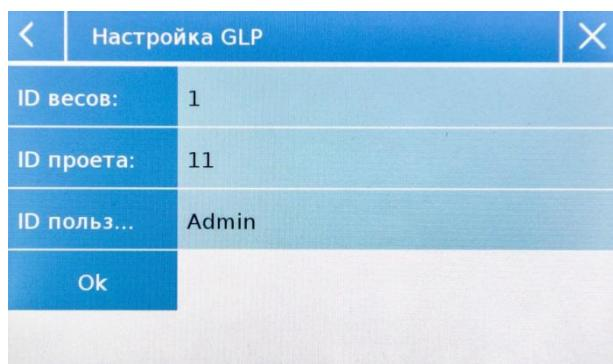
Отобразится экран ввода данных. Коснитесь соответствующего параметра, чтобы ввести нужные данные. Максимальное количество символов для одного параметра равно 20.
