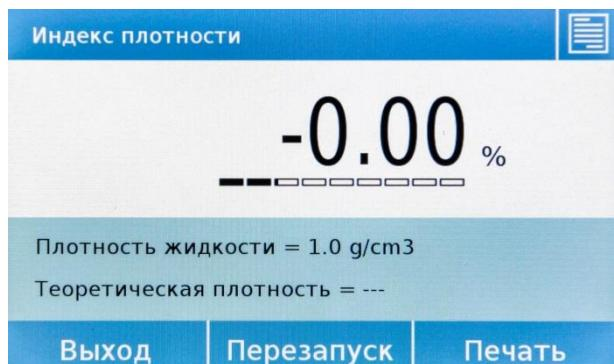
Коснитесь клавиши «Выход», чтобы выйти из функции, клавиши «Перезапуск», чтобы выполнить новое измерение, и клавиши «Печать», чтобы распечатать результат измерения.
