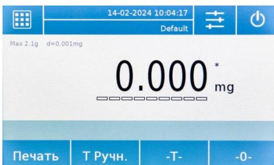
Если вес тары вводился вручную, для его удаления нажмите “Т Ручн.” и затем “C”.
