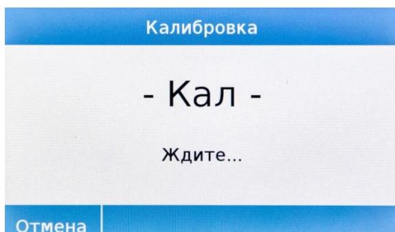
**Калибровка:** коснитесь клавиши "Калибровка", калибровка запустится в соответствии с установленном режимом калибровки.
