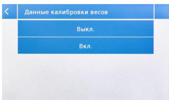
**Данные калибровки весов:** позволяет включать или отключать печать данных калибровки весов.
