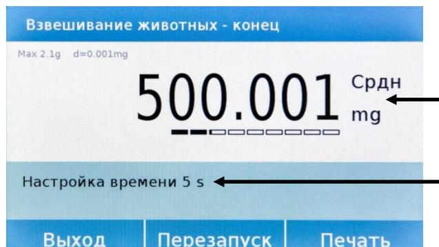
Коснитесь клавиши «Выход», чтобы выйти из функции, клавиши «Перезапуск», чтобы выполнить новое измерение, и клавиши «Печать», чтобы распечатать результат измерения result.
